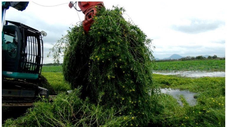
写真 2：琵琶湖畔に群生する外来水生植物のオオバナミズキンバイ。特殊な装備を備えた建設機械を利用して、効率的な刈取りが進められている。水草は最終的に地場で焼却処分するため、実はこの後に続く水切り・乾燥に苦勞する。
